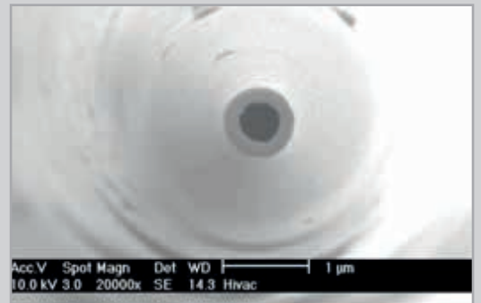
玻璃孔口——扫描电子显微镜尖端图像，直径：0.4 微米
